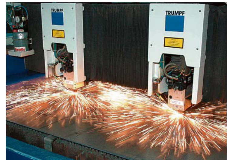
Laserschneid-Anlage Trumpf TC HSL 4002C mit zwei Laserschneidköpfen.
